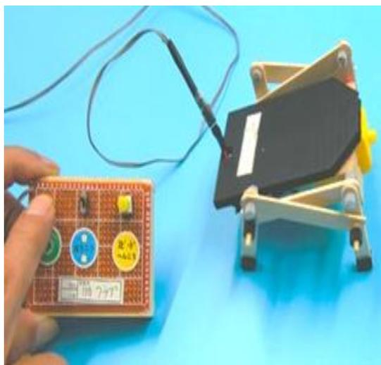
モーターを回しリンク機構を使い4足歩行を行うロボットです。リモコンで操作します。
